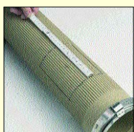
3.4 Vložku vyřezat a podle obrázku vyřezat oděnek 11,6 x 14,5 cm (šířka x výška).
